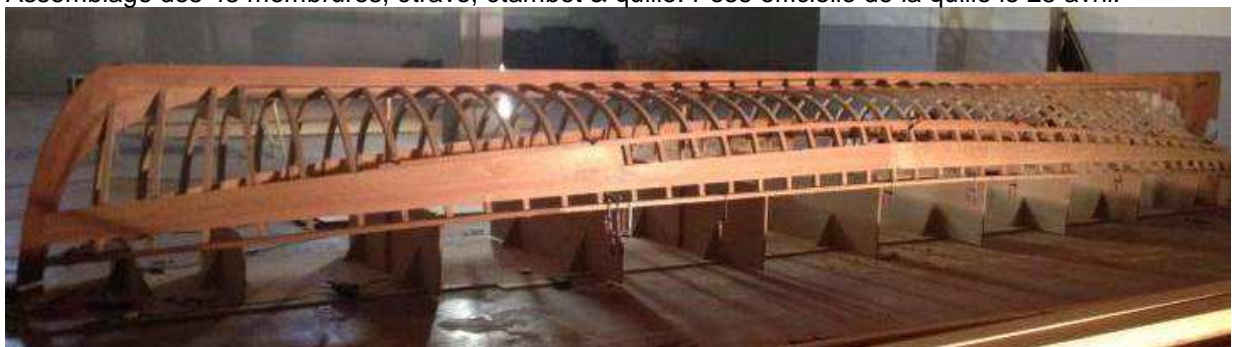
Assemblage des 43 membrures, étrave, étambot & quille. Pose officielle de la quille le 25 avril.
