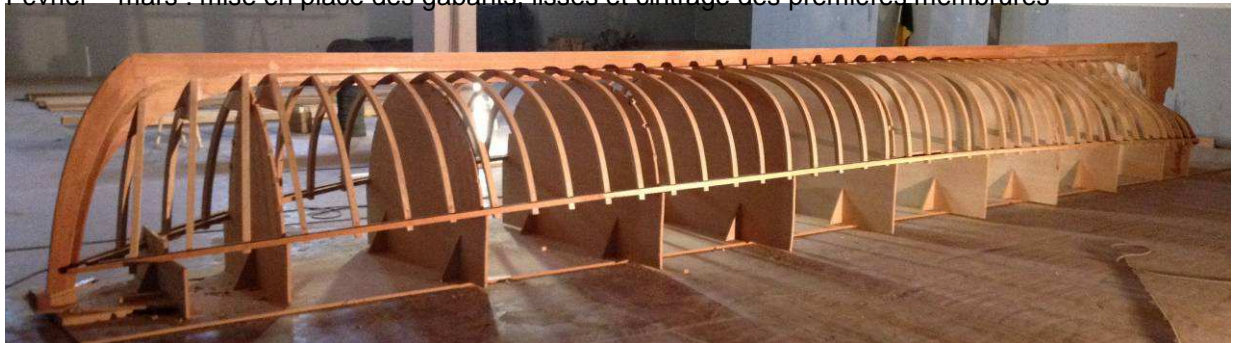
Assemblage des 43 membrures, étrave, étambot & quille. Pose officielle de la quille le 25 avril.
